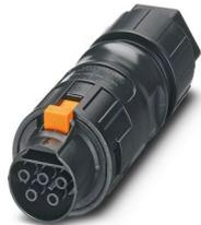
PRC-Prüfstecker, 2000 Steckzyklen, handentriegelbar, schwarz, 5-polig, 1,5 mm<sup>2</sup> ... 6 mm<sup>2</sup> / 690 V / 35 A, mit Schraubanschluss für Leitungen mit dem Außendurchmesser 8 mm ... 21 mm.
