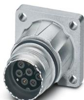
Gerätesteckverbinder Vorderwand, gerade, für Standard- und SPEEDCON-Verriegelung, M17, Polzahl: 5+3+PE, Kontaktart: Stift, O-Ring axial, geschirmt: ja, Flanschmaß: 25,75 mm x 25,75 mm, Polzahl: 9, Anschlussart: Crimpanschluss, Serie: ST
