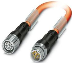
Steckverbinder beidseitig kunststoffumspritzt, Serie: KSF, M23-Buchse, gerade kunststoffumspritzt, Polzahl: 4+3+PE, Verriegelungsart: Schraubverriegelung, auf M23-Stift, gerade kunststoffumspritzt, Polzahl: 4+3+PE, Kabellänge: 10 m, geschirmt: ja, Farbe Außenmantel: orange RAL 2003, dieser Artikel ist voraussichtlich ab 2027-Q1 nach RoHS II ohne Ausnahme 6c (Pb < 0,1 %) bleifrei, auf Anfrage ist eine bleifreie Alternative vorab möglich
