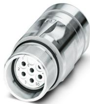
M23, Kupplungssteckverbinder, Serie: CA, gerade, geschirmt: ja, für Standard- und SPEEDCON-Verriegelung, Polzahl: 7, Drehsinn: Standard, Kontaktart: Buchse, Lötanschluss, Kabeldurchmesserbereich: 3 mm ... 14,5 mm, Kodierung: N, dieser Artikel ist voraussichtlich ab 2026-Q1 nach RoHS II ohne Ausnahme 6c (Pb < 0,1 %) bleifrei, auf Anfrage ist eine bleifreie Alternative vorab möglich
