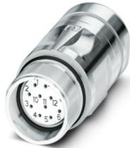
M23, Kupplungssteckverbinder, Serie: CA, gerade, geschirmt: ja, für Standard- und SPEEDCON-Verriegelung, Polzahl: 12, Drehsinn: Standard, Kontaktart: Buchse, Crimpanschluss, Kabeldurchmesserbereich: 3 mm ... 14,5 mm, Kodierung: N, dieser Artikel ist voraussichtlich ab 2026-Q1 nach RoHS II ohne Ausnahme 6c (Pb < 0,1 %) bleifrei, auf Anfrage ist eine bleifreie Alternative vorab möglich
