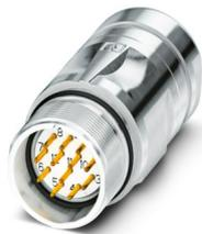
M23, Kupplungssteckverbinder, Serie: CA, gerade, geschirmt: ja, für Standard- und SPEEDCON-Verriegelung, Polzahl: 16+3, Drehsinn: Standard, Kontaktart: Stift, Lötanschluss, Kabeldurchmesserbereich: 3 mm ... 14,5 mm, Kodierung: N, dieser Artikel ist voraussichtlich ab 2026-Q1 nach RoHS II ohne Ausnahme 6c (Pb < 0,1 %) bleifrei, auf Anfrage ist eine bleifreie Alternative vorab möglich
