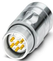
M23, Kupplungssteckverbinder, Serie: CA, gerade, geschirmt: ja, für Standard- und SPEEDCON-Verriegelung, Polzahl: 7, Drehsinn: Standard, Kontaktart: Stift, Crimpanschluss, Kabeldurchmesserbereich: 4 mm ... 6 mm, Kodierung: N, dieser Artikel ist voraussichtlich ab 2026-Q1 nach RoHS II ohne Ausnahme 6c (Pb < 0,1 %) bleifrei, auf Anfrage ist eine bleifreie Alternative vorab möglich
