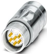
M23, Kupplungssteckverbinder, Serie: CA, gerade, geschirmt: ja, für Standard- und SPEEDCON-Verriegelung, Polzahl: 6, Drehsinn: Standard, Kontaktart: Stift, Crimpanschluss, Kabeldurchmesserbereich: 6 mm ... 10 mm, Kodierung: N, dieser Artikel ist voraussichtlich ab 2026-Q1 nach RoHS II ohne Ausnahme 6c (Pb < 0,1 %) bleifrei, auf Anfrage ist eine bleifreie Alternative vorab möglich
