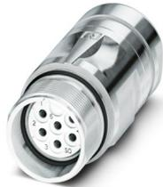
M23, Kupplungssteckverbinder, Serie: CA, gerade, geschirmt: ja, für Standard- und SPEEDCON-Verriegelung, Polzahl: 8+1, Drehsinn: Standard, Kontaktart: Buchse, Lötanschluss, Kabeldurchmesserbereich: 6 mm ... 10 mm, Kodierung: N, dieser Artikel ist voraussichtlich ab 2026-Q1 nach RoHS II ohne Ausnahme 6c (Pb < 0,1 %) bleifrei, auf Anfrage ist eine bleifreie Alternative vorab möglich
