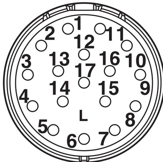
Kontaktkammernummerierung (Ansicht Steckseite) Buchse Standard
