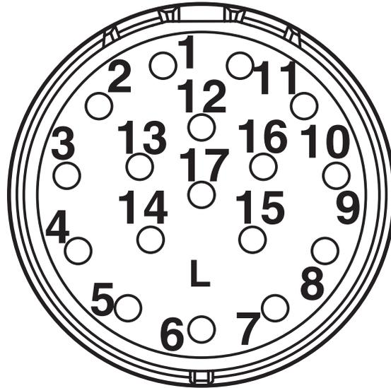
Kontaktkammernummerierung (Ansicht Steckseite) Buchse Standard
