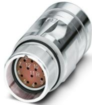
M23, Kupplungssteckverbinder, Serie: CA, gerade, geschirmt: ja, für Standard- und SPEEDCON-Verriegelung, Polzahl: 17, Drehsinn: Standard, Kontaktart: Buchse, Crimpanschluss, Kabeldurchmesserbereich: 3 mm ... 14,5 mm, Kodierung: N
