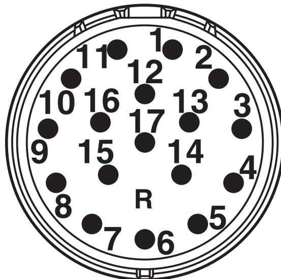
Kontaktkammernummerierung (Ansicht Steckseite) Stift Standard
