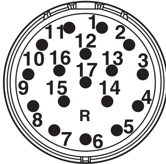
Kontaktkammernummerierung (Ansicht Steckseite) Stift Standard
