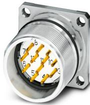
M23, Gerätesteckverbinder Vorderwand, Serie: CA, gerade, geschirmt: ja, für Standard- und SPEEDCON-Verriegelung, Polzahl: 17, Drehsinn: Standard, Kontaktart: Stift, Lötanschluss, Flachdichtung, Flanschmaß: 25 mm x 25 mm, Kodierung: N, dieser Artikel ist voraussichtlich ab 2025-Q3 nach RoHS II ohne Ausnahme 6c (Pb < 0,1 %) bleifrei, auf Anfrage ist eine bleifreie Alternative vorab möglich
