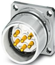
M23, Gerätesteckverbinder Vorderwand, Serie: CA, gerade, geschirmt: ja, für Standard- und SPEEDCON-Verriegelung, Polzahl: 7, Drehsinn: Standard, Kontaktart: Stift, Einlötlanschluss, Flachdichtung, Flanschmaß: 25 mm x 25 mm, Kodierung: N, dieser Artikel ist voraussichtlich ab 2027-Q1 nach RoHS II ohne Ausnahme 6c (Pb < 0,1 %) bleifrei, auf Anfrage ist eine bleifreie Alternative vorab möglich
