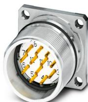
M23, Gerätesteckverbinder Vorderwand, Serie: CA, gerade, geschirmt: ja, für Standard- und SPEEDCON-Verriegelung, Polzahl: 17, Drehsinn: Standard, Kontaktart: Stift, Einlötlanschluss, Flachdichtung, Flanschmaß: 25 mm x 25 mm, Kodierung: N, dieser Artikel ist voraussichtlich ab 2025-Q3 nach RoHS II ohne Ausnahme 6c (Pb < 0,1 %) bleifrei, auf Anfrage ist eine bleifreie Alternative vorab möglich
