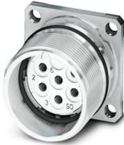
M23, Gerätesteckverbinder Vorderwand, Serie: CA, gerade, geschirmt: ja, für Standard- und SPEEDCON-Verriegelung, Polzahl: 7, Drehsinn: Standard, Kontaktart: Buchse, Einlötlanschluss, Flachdichtung, Flanschmaß: 25 mm x 25 mm, Kodierung: N, dieser Artikel ist voraussichtlich ab 2027-Q1 nach RoHS II ohne Ausnahme 6c (Pb < 0,1 %) bleifrei, auf Anfrage ist eine bleifreie Alternative vorab möglich
