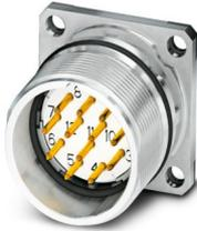
M23, Gerätesteckverbinder Vorderwand, Serie: CA, gerade, geschirmt: ja, für Standard- und SPEEDCON-Verriegelung, Polzahl: 12, Drehsinn: Standard, Kontaktart: Stift, Einlötlanschluss, Flachdichtung, Flanschmaß: 25 mm x 25 mm, Kodierung: N, dieser Artikel ist voraussichtlich ab 2025-Q4 nach RoHS II ohne Ausnahme 6c (Pb < 0,1 %) bleifrei, auf Anfrage ist eine bleifreie Alternative vorab möglich
