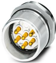
M23, Gerätesteckverbinder Vorderwand, Serie: CA, gerade, geschirmt: ja, für Standard- und SPEEDCON-Verriegelung, Polzahl: 7, Drehsinn: Standard, Kontaktart: Stift, Lötanschluss, Axialdichtung, Kodierung: N, dieser Artikel ist voraussichtlich ab 2025-Q3 nach RoHS II ohne Ausnahme 6c (Pb < 0,1 %) bleifrei, auf Anfrage ist eine bleifreie Alternative vorab möglich
