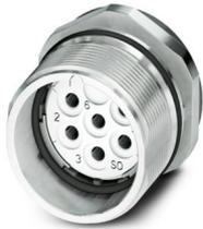
M23, Gerätesteckverbinder Vorderwand, Serie: CA, gerade, geschirmt: ja, für Standard- und SPEEDCON-Verriegelung, Polzahl: 8+1, Drehsinn: Standard, Kontaktart: Buchse, Lötanschluss, Axialdichtung, Kodierung: N, dieser Artikel ist voraussichtlich ab 2025-Q3 nach RoHS II ohne Ausnahme 6c (Pb < 0,1 %) bleifrei, auf Anfrage ist eine bleifreie Alternative vorab möglich
