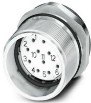
M23, Gerätesteckverbinder Vorderwand, Serie: CA, gerade, geschirmt: ja, für Standard- und SPEEDCON-Verriegelung, Polzahl: 12, Drehsinn: Standard, Kontaktart: Buchse, Crimpanschluss, Axialdichtung, Kodierung: N
