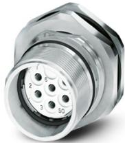
M23, Gerätesteckverbinder Hinterwand, Serie: CA, gerade, geschirmt: ja, für Standard- und SPEEDCON-Verriegelung, Polzahl: 8+1, Drehsinn: Standard, Kontaktart: Buchse, Lötanschluss, Axialdichtung, Kodierung: N, dieser Artikel ist voraussichtlich ab 2027-Q1 nach RoHS II ohne Ausnahme 6c (Pb < 0,1 %) bleifrei, auf Anfrage ist eine bleifreie Alternative vorab möglich
