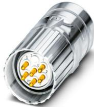
M23, Kabelsteckverbinder, Serie: CA, gerade, geschirmt: ja, Schraubverriegelung, Polzahl: 8+1, Drehsinn: Standard, Kontaktart: Stift, Crimpanschluss, Kabeldurchmesserbereich: 3 mm ... 14,5 mm, Kodierung: N, dieser Artikel ist voraussichtlich ab 2026-Q2 nach RoHS II ohne Ausnahme 6c (Pb < 0,1 %) bleifrei, auf Anfrage ist eine bleifreie Alternative vorab möglich
