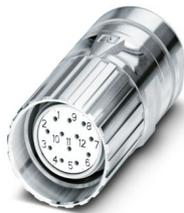
M23, Kabelsteckverbinder, Serie: CA, gerade, geschirmt: ja, Schraubverriegelung, Polzahl: 12, Drehsinn: Standard, Kontaktart: Buchse, Lötanschluss, Kabeldurchmesserbereich: 3 mm ... 14,5 mm, Kodierung: N, dieser Artikel ist voraussichtlich ab 2026-Q2 nach RoHS II ohne Ausnahme 6c (Pb < 0,1 %) bleifrei, auf Anfrage ist eine bleifreie Alternative vorab möglich
