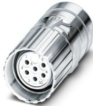
M23, Kabelsteckverbinder, Serie: CA, gerade, geschirmt: ja, Schraubverriegelung, Polzahl: 7, Drehsinn: Standard, Kontaktart: Buchse, Lötanschluss, Kabeldurchmesserbereich: 10 mm ... 14,5 mm, Kodierung: N, dieser Artikel ist voraussichtlich ab 2026-Q2 nach RoHS II ohne Ausnahme 6c (Pb < 0,1 %) bleifrei, auf Anfrage ist eine bleifreie Alternative vorab möglich
