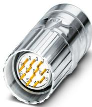
M23, Kabelsteckverbinder, Serie: CA, gerade, geschirmt: ja, Schraubverriegelung, Polzahl: 16, Drehsinn: Standard, Kontaktart: Stift, Lötanschluss, Kabeldurchmesserbereich: 10 mm ... 14,5 mm, Kodierung: N, dieser Artikel ist voraussichtlich ab 2026-Q2 nach RoHS II ohne Ausnahme 6c (Pb < 0,1 %) bleifrei, auf Anfrage ist eine bleifreie Alternative vorab möglich
