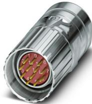
M23, Kabelsteckverbinder, Serie: CA, gerade, geschirmt: ja, Schraubverriegelung, Polzahl: 12, Drehsinn: Gegenlauf, Kontaktart: Stift, Crimpanschluss, Kabeldurchmesserbereich: 3 mm ... 14,5 mm, Kodierung: N
