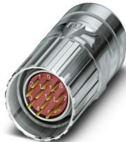
M23, Kabelsteckverbinder, Serie: CA, gerade, geschirmt: ja, Schraubverriegelung, Polzahl: 17, Drehsinn: Standard, Kontaktart: Stift, Crimpanschluss, Kabeldurchmesserbereich: 10 mm ... 14,5 mm, Kodierung: N. Dieses Produkt befindet sich in einem Abkündigungsprozess. Für neue Projekte darf dieses Produkt nicht mehr berücksichtigt werden. Bitte wenden Sie sich für Alternativen an Ihren zuständigen Vertriebsmitarbeiter.
