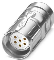
M23, Kabelsteckverbinder, Serie: CA, gerade, geschirmt: ja, SPEEDCON, Polzahl: 6, Drehsinn: Standard, Kontaktart: Buchse, Lötanschluss, Kabeldurchmesserbereich: 3 mm ... 14,5 mm, Kodierung: N
