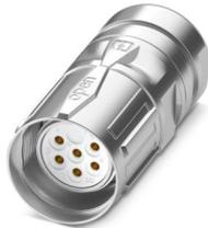
M23, Kabelsteckverbinder, Serie: CA, gerade, geschirmt: ja, SPEEDCON, Polzahl: 7, Drehsinn: Standard, Kontaktart: Buchse, Lötanschluss, Kabeldurchmesserbereich: 3 mm ... 14,5 mm, Kodierung: N, dieser Artikel ist voraussichtlich ab 2026-Q1 nach RoHS II ohne Ausnahme 6c (Pb < 0,1 %) bleifrei, auf Anfrage ist eine bleifreie Alternative vorab möglich
