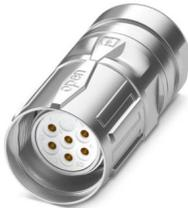
M23, Kabelsteckverbinder, Serie: CA, gerade, geschirmt: ja, SPEEDCON, Polzahl: 8+1, Drehsinn: Standard, Kontaktart: Buchse, Lötanschluss, Kabeldurchmesserbereich: 3 mm ... 14,5 mm, Kodierung: N, dieser Artikel ist voraussichtlich ab 2026-Q1 nach RoHS II ohne Ausnahme 6c (Pb < 0,1 %) bleifrei, auf Anfrage ist eine bleifreie Alternative vorab möglich
