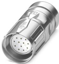
M23, Kabelsteckverbinder, Serie: CA, gerade, geschirmt: ja, SPEEDCON, Polzahl: 16, Drehsinn: Standard, Kontaktart: Buchse, Lötanschluss, Kabeldurchmesserbereich: 3 mm ... 14,5 mm, Kodierung: N, dieser Artikel ist voraussichtlich ab 2026-Q1 nach RoHS II ohne Ausnahme 6c (Pb < 0,1 %) bleifrei, auf Anfrage ist eine bleifreie Alternative vorab möglich
