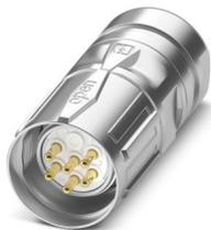
M23, Kabelsteckverbinder, Serie: CA, gerade, geschirmt: ja, SPEEDCON, Polzahl: 8+1, Drehsinn: Standard, Kontaktart: Stift, Crimpanschluss, Kabeldurchmesserbereich: 4 mm ... 6 mm, Kodierung: N
