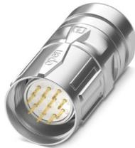
M23, Kabelsteckverbinder, Serie: CA, gerade, geschirmt: ja, SPEEDCON, Polzahl: 12, Drehsinn: Standard, Kontaktart: Stift, Crimpanschluss, Kabeldurchmesserbereich: 6 mm ... 10 mm, Kodierung: N, dieser Artikel ist voraussichtlich ab 2026-Q1 nach RoHS II ohne Ausnahme 6c (Pb < 0,1 %) bleifrei, auf Anfrage ist eine bleifreie Alternative vorab möglich
