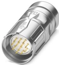
M23, Kabelsteckverbinder, Serie: CA, gerade, geschirmt: ja, SPEEDCON, Polzahl: 12, Drehsinn: Standard, Kontaktart: Stift, Crimpanschluss, Kabeldurchmesserbereich: 10 mm ... 14,5 mm, Kodierung: N. Dieses Produkt befindet sich in einem Abkündigungsprozess. Für neue Projekte darf dieses Produkt nicht mehr berücksichtigt werden. Bitte wenden Sie sich für Alternativen an Ihren zuständigen Vertriebsmitarbeiter.
