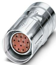
M23, Kabelsteckverbinder, Serie: CA, gerade, geschirmt: ja, SPEEDCON, Polzahl: 12, Drehsinn: Standard, Kontaktart: Buchse, Crimpanschluss, Kabeldurchmesserbereich: 6 mm ... 10 mm, Kodierung: N, dieser Artikel ist voraussichtlich ab 2026-Q1 nach RoHS II ohne Ausnahme 6c (Pb < 0,1 %) bleifrei, auf Anfrage ist eine bleifreie Alternative vorab möglich
