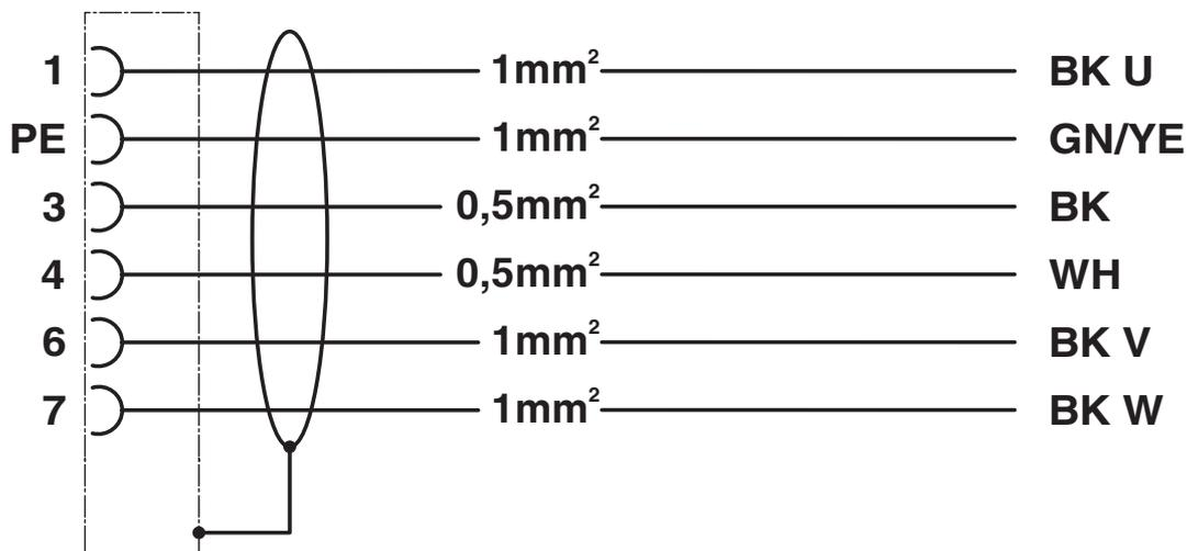
Kontaktbelegung der M17-Stecker/Buchsen, Kabeltyp C01
