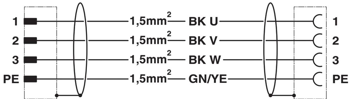
Kontaktbelegung der M17-Stecker/Buchsen, Kabeltyp B00
