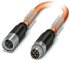
Steckverbinder beidseitig kunststoffumspritzt, Serie: KST, M17-Buchse, gerade kunststoffumspritzt, Polzahl: 3+PE, Verriegelungsart: Schraubverriegelung, auf M17-Stift, gerade kunststoffumspritzt, Polzahl: 3+PE, Kabellänge: 2 m, geschirmt: ja, Farbe Außenmantel: orange RAL 2003, dieser Artikel ist voraussichtlich ab 2027-Q1 nach RoHS II ohne Ausnahme 6c (Pb < 0,1 %) bleifrei, auf Anfrage ist eine bleifreie Alternative vorab möglich
