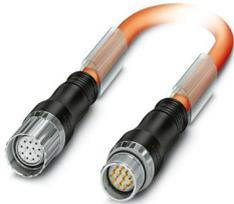
Steckverbinder beidseitig kunststoffumspritzt, gerade kunststoffumspritzt, Polzahl: 12, Verriegelungsart: Schraubverriegelung, gerade kunststoffumspritzt, geschirmt: ja, Farbe Außenmantel: orange RAL 2003, dieser Artikel ist voraussichtlich ab 2027-Q1 nach RoHS II ohne Ausnahme 6c (Pb < 0,1 %) bleifrei, auf Anfrage ist eine bleifreie Alternative vorab möglich
