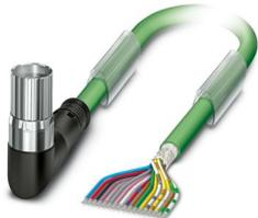
Kabelstecker kunststoffumspritzt, M23-Buchse, gewinkelt drehbar, -120° links / 120° rechts, Polzahl: 17, Verriegelungsart: Schraubverriegelung, Kabellänge: 2 m, geschirmt: ja, Farbe Außenmantel: grün, dieser Artikel ist voraussichtlich ab 2027-Q1 nach RoHS II ohne Ausnahme 6c (Pb < 0,1 %) bleifrei, auf Anfrage ist eine bleifreie Alternative vorab möglich
