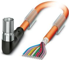
Kabelstecker kunststoffumspritzt, gewinkelt drehbar, -120° links / 120° rechts, Polzahl: 12, Verriegelungsart: Schraubverriegelung, Kabellänge: 5 m, geschirmt: ja, Farbe Außenmantel: orange RAL 2003, dieser Artikel ist voraussichtlich ab 2027-Q1 nach RoHS II ohne Ausnahme 6c (Pb < 0,1 %) bleifrei, auf Anfrage ist eine bleifreie Alternative vorab möglich
