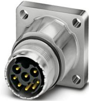
Gerätesteckverbinder Vorderwand, gerade, für Standard- und SPEEDCON-Verriegelung, M17, Polzahl: 17, Kontaktart: Stift, O-Ring axial, geschirmt: ja, Flanschmaß: 25,75 mm x 25,75 mm, Polzahl: 17, Anschlussart: Crimpanschluss, Serie: ST
