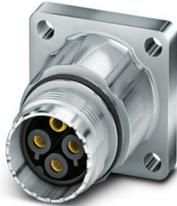
Gerätesteckverbinder Vorderwand, gerade, für Standard- und SPEEDCON-Verriegelung, M17, Polzahl: 5+PE, Kontaktart: Stift, O-Ring axial, geschirmt: ja, Flanschmaß: 25,75 mm x 25,75 mm, Polzahl: 6, Anschlussart: Crimpanschluss, Serie: ST
