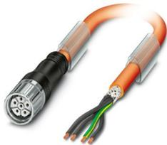
Kabelstecker kunststoffumspritzt, Serie: KSF, M23-Buchse, gerade kunststoffumspritzt, Polzahl: 5+PE, Verriegelungsart: Schraubverriegelung, Kabellänge: 10 m, geschirmt: ja, Farbe Außenmantel: orange RAL 2003, dieser Artikel ist voraussichtlich ab 2027-Q1 nach RoHS II ohne Ausnahme 6c (Pb < 0,1 %) bleifrei, auf Anfrage ist eine bleifreie Alternative vorab möglich
