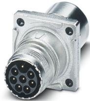
Durchführung Vorderwand, gerade, SPEEDCON, M17, Polzahl: 5+3+PE, Kontaktart: Stift, Flachdichtung, geschirmt: ja, Flanschmaß: 25,75 mm x 25,75 mm, Kabeldurchmesserbereich: 5 mm ... 9 mm, Polzahl: 9, Anschlussart: Crimpanschluss, Serie: ST, dieser Artikel ist voraussichtlich ab 2026-Q4 nach RoHS II ohne Ausnahme 6c (Pb < 0,1 %) bleifrei, auf Anfrage ist eine bleifreie Alternative vorab möglich
