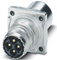
Durchführung Vorderwand, gerade, SPEEDCON, M17, Polzahl: 5+PE, Kontaktart: Stift, Flachdichtung, geschirmt: ja, Flanschmaß: 25,75 mm x 25,75 mm, Kabeldurchmesserbereich: 3,5 mm ... 5,5 mm, Polzahl: 6, Anschlussart: Crimpanschluss, Serie: ST, dieser Artikel ist voraussichtlich ab 2026-Q2 nach RoHS II ohne Ausnahme 6c (Pb < 0,1 %) bleifrei, auf Anfrage ist eine bleifreie Alternative vorab möglich
