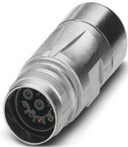
Kupplungssteckverbinder, gerade, für Standard- und SPEEDCON-Verriegelung, M17, Polzahl: 17, Kontaktart: Buchse, geschirmt: ja, Schutzart: IP67, Kabeldurchmesserbereich: 5 mm ... 9,2 mm, Polzahl: 17, Anschlussart: Crimpanschluss, Serie: ST, dieser Artikel ist voraussichtlich ab 2025-Q4 nach RoHS II ohne Ausnahme 6c (Pb < 0,1 %) bleifrei, auf Anfrage ist eine bleifreie Alternative vorab möglich
