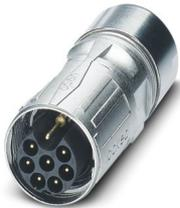
Kabelsteckverbinder, gerade, SPEEDCON, M17, Polzahl: 7+PE, Kontaktart: Stift, geschirmt: ja, Schutzart: IP67, Kabeldurchmesserbereich: 3,5 mm ... 5,5 mm, Polzahl: 8, Anschlussart: Crimpanschluss, Serie: ST, dieser Artikel ist voraussichtlich ab 2026-Q2 nach RoHS II ohne Ausnahme 6c (Pb < 0,1 %) bleifrei, auf Anfrage ist eine bleifreie Alternative vorab möglich
