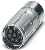
Kabelsteckverbinder, gerade, SPEEDCON, M17, Polzahl: 7+PE, Kontaktart: Buchse, geschirmt: ja, Schutzart: IP67, Kabeldurchmesserbereich: 9 mm ... 11,2 mm, Polzahl: 8, Anschlussart: Crimpanschluss, Serie: ST, dieser Artikel ist voraussichtlich ab 2026-Q4 nach RoHS II ohne Ausnahme 6c (Pb < 0,1 %) bleifrei, auf Anfrage ist eine bleifreie Alternative vorab möglich
