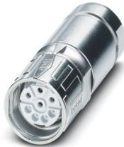
Kabelsteckverbinder, SPEEDCON, M23, Polzahl: 5+PE, Kontaktart: Buchse, geschirmt: ja, Schutzart: IP67, Kabeldurchmesserbereich: 9 mm ... 12 mm, Polzahl: 6, Anschlussart: Crimpanschluss, Serie: SF, dieser Artikel ist voraussichtlich ab 2026-Q1 nach RoHS II ohne Ausnahme 6c (Pb < 0,1 %) bleifrei, auf Anfrage ist eine bleifreie Alternative vorab möglich
