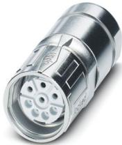
Kabelsteckverbinder, gerade kurz, SPEEDCON, M23, Polzahl: 5+PE, Kontaktart: Buchse, geschirmt: ja, Schutzart: IP67, Kabeldurchmesserbereich: 9 mm ... 11 mm, Polzahl: 6, Anschlussart: Crimpanschluss, Serie: SF, dieser Artikel ist voraussichtlich ab 2027-Q1 nach RoHS II ohne Ausnahme 6c (Pb < 0,1 %) bleifrei, auf Anfrage ist eine bleifreie Alternative vorab möglich
