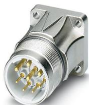
Gerätesteckverbinder Vorderwand, gerade, SPEEDCON, M23, Polzahl: 5+PE, Kontaktart: Stift, O-Ring axial, geschirmt: ja, Flanschmaß: 26 mm x 26 mm, Polzahl: 6, Anschlussart: Crimpanschluss, Serie: SF
